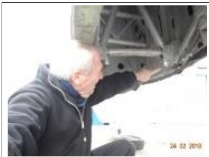
*Am 24. Februar: Vorbereitungs-Kontrollen im Bereich der Fahrwerksschächte. Hier sind größere Unfallschäden im Bereich der Fahrwerksstruktur zu reparieren.*
