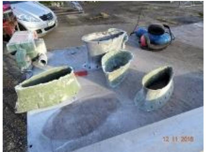
Am 12. November: Das Projekt zur Herstellung / „Klonen – Kopieren“ von zwei ADF-Loop-Antennen wurde gestartet. Hier sieht man die Rohlinge für die Antennen - Füße
