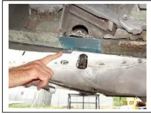
Am 28. Juli: Die Beplankung der Struktur im Randbereich des Fahrwerkschachtes rechts wird repariert. Roger wird im Verlauf der mehrwöchigen Arbeiten von Dieter, Christian und Walti unterstützt.
