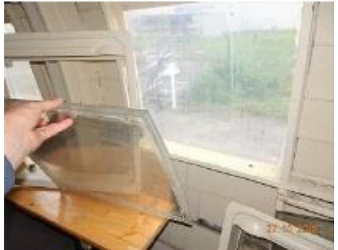
Am 27. Oktober: Das Projekt zur Reparatur der Kabinenfenster wurde gestartet. Die vorhandenen Originalfenster wurden zerlegt, und die Einzelteile müssen noch instand gestellt werden. Die fehlenden, vier kompletten Kabinenfenster müssen vom Viking-Team selbst hergestellt werden. Dazu ist eine „Klon“-Kopier-Aktion notwendig.
