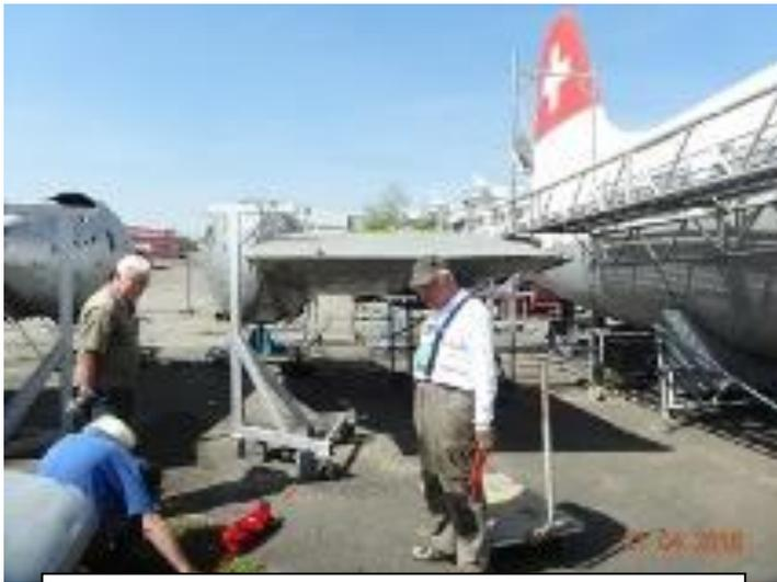
Am 21. April: Die Abstützung des linken Innenflügels wird repariert und am Boden gesichert.
