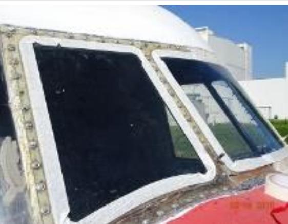
Die Instandstellung der Cockpit – Frontscheiben wurde begonnen. Die drei Frontscheiben befinden sich im Originalzustand, Die Fensterrahmen müssen repariert werden.
