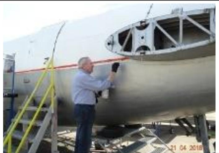
Anbringen der ersten „Cheat-Line“, zur optischen Beeinflussung der Rumpfkontur und zur Identifizierung der entsprechenden Airline.
