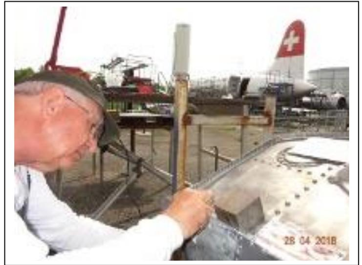
Am 28. April: Es wird weiter an der Instandstellung des Reserve-Benzintank der Viking gearbeitet.
