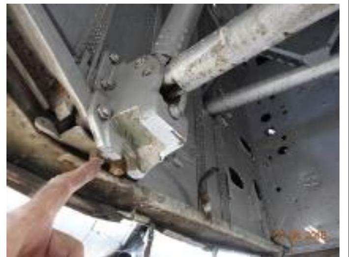
Hier die defekte, linke Achslagerung am Fahrwerk links.
