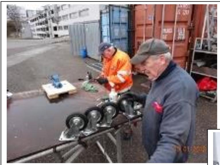
*Die Schwenkrollen wurden zerlegt, gereinigt, teilweise repariert und gebrauchsfertig instandgestellt.*
