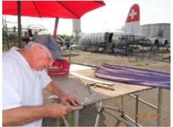
Am 4.Aug.: Die Reparaturarbeiten an der Beplankung des Fahrwerkschachts werden fortgeführt
