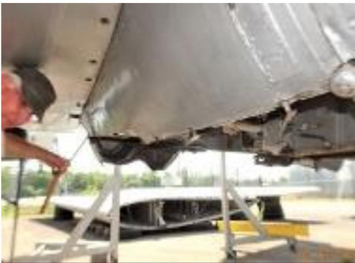
Roger kontrolliert die Beschädigungen an der Beplankung des rechten Fahrwerkschachts.
