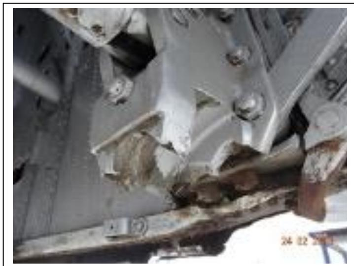
*Bedingt durch den Landeunfall des Flugzeugs im Jahre 1953 ist die Struktur der Fahrwerks-Aufhängung links stark beschädigt.*
