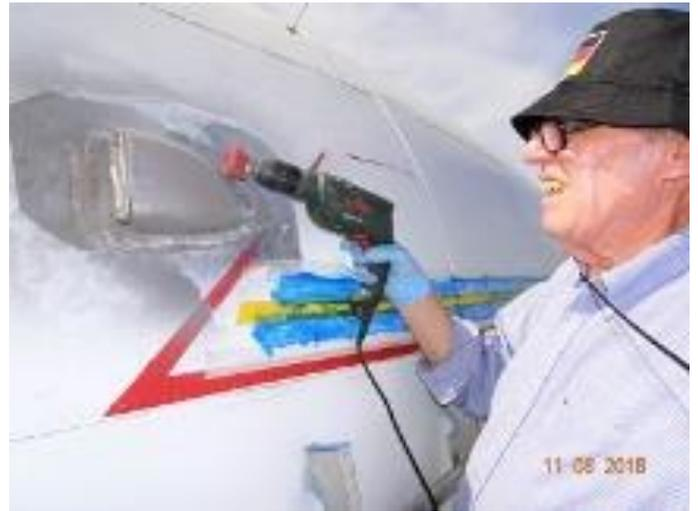
Lokale Instandstellungen am Lüftungs-Einlass, links im Bereich Cockpit.
