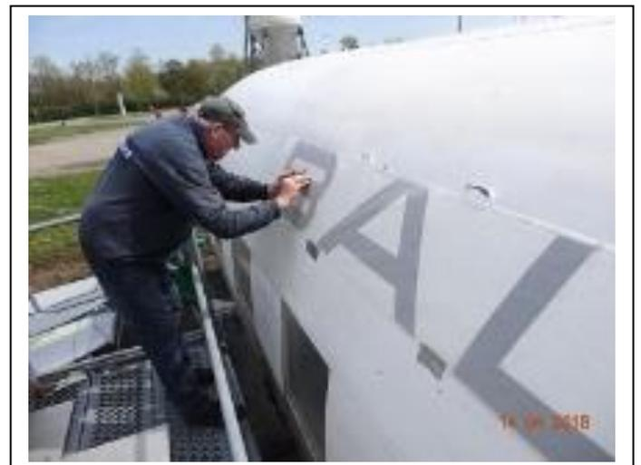
*Hier wird eine Schablone der BALAIR-Beschriftung für die rechte Rumpfseite angefertigt.*
