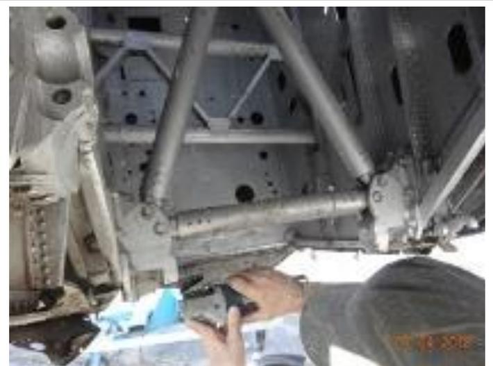
Ab 7. April wurden Reparaturarbeiten im Bereich der Fahrwerks-Aufhängung durchgeführt. Es sind erhebliche Beschädigungen / Deformationen in stand zu stellen. Die Fotos zeigen den linken Fahrwerks-Schacht. Hier inspiziert Roger die abgebrochenen Drehpunkte der Fahrwerksbeine. Diese werden plan geschliffen, um dann neue, untere Halbschalen zu montieren.
