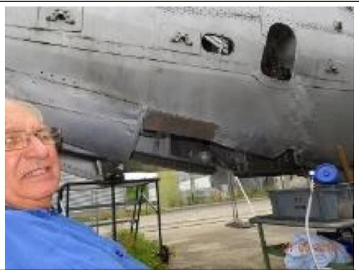
*Am 1. September: Die Reparaturen am Fahrwerkschat recht werden weitergeführt. Die Struktur der Fahrwerksbefestigung und die Beplankung sind stark deformiert.*
