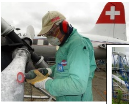
Instandstellen der Propellerblätter
