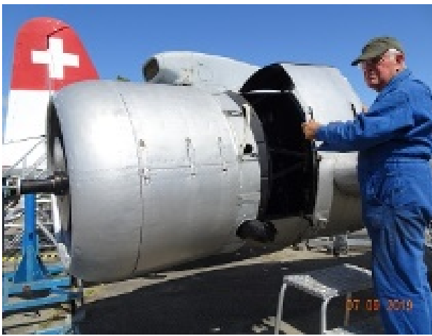
Arbeiten am linken „Motor“ am Schmiersystem der Propellerwelle
